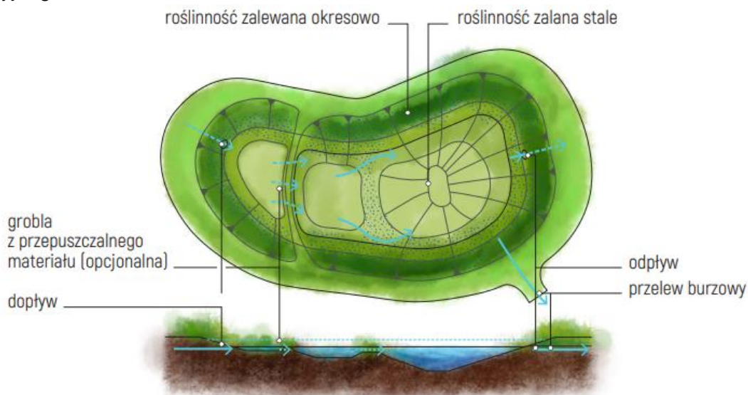
Rysunek 47. Schemat typowego stawu retencyjnego, widok z góry i przekrój
